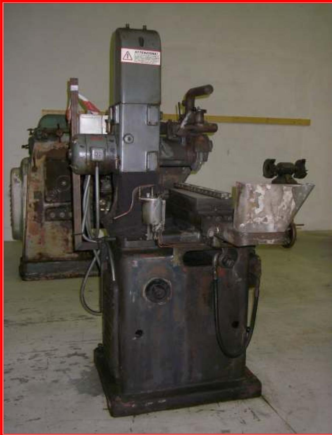
Retro della rettificatrice: motore mandrino, quadro derivazioni elettriche, protezione in tessuto alla guida di scorrimento verticale della testa porta mola, basamento con feritoie di aerazione gruppo pompe idrauliche
