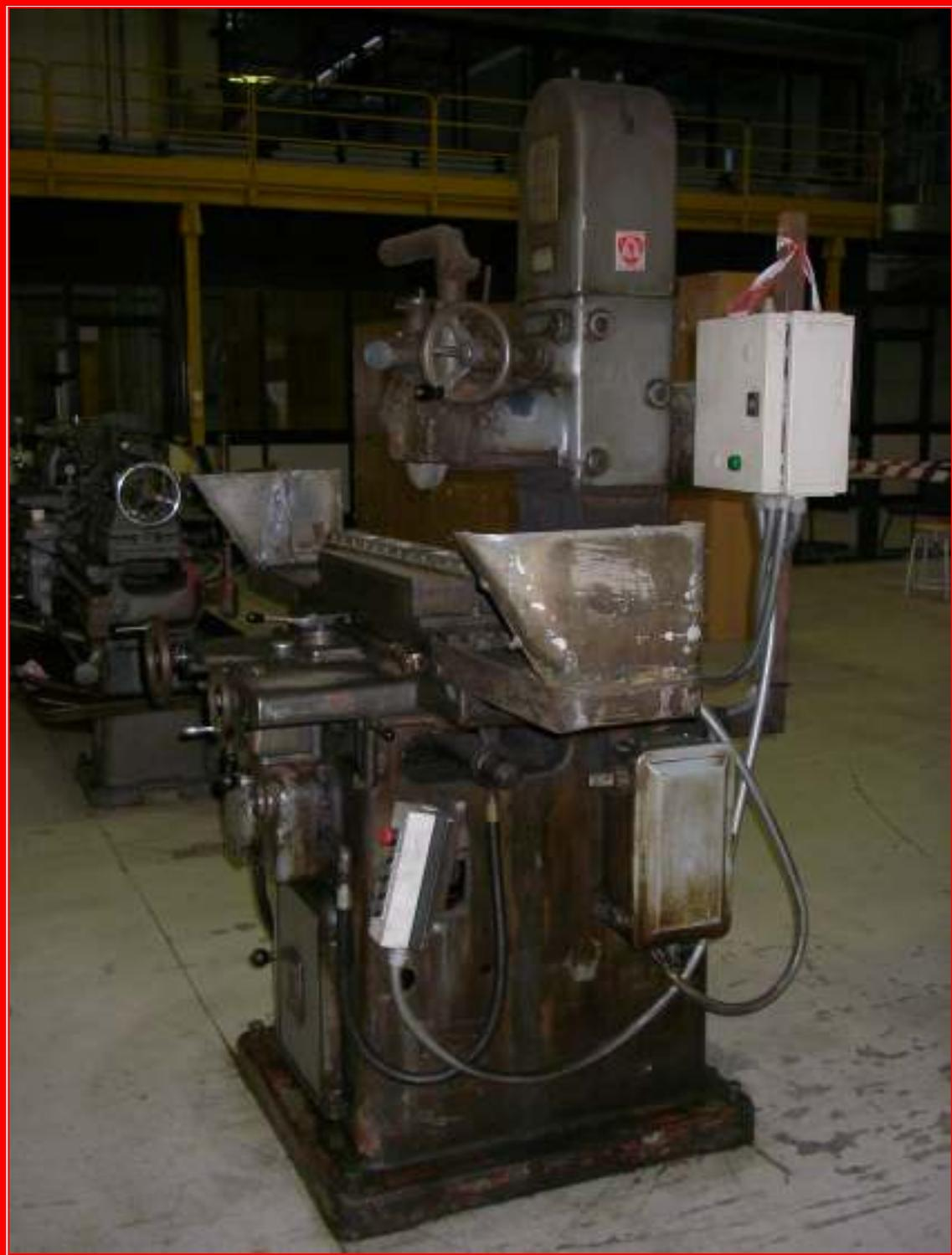
Particolare: utensile ravnivatore diamantato della mola con leva di comando e volantino micrometrico di abbassamento, mola senza carter di protezione, condotta di aspirazione, volantino movimento verticale della testa
