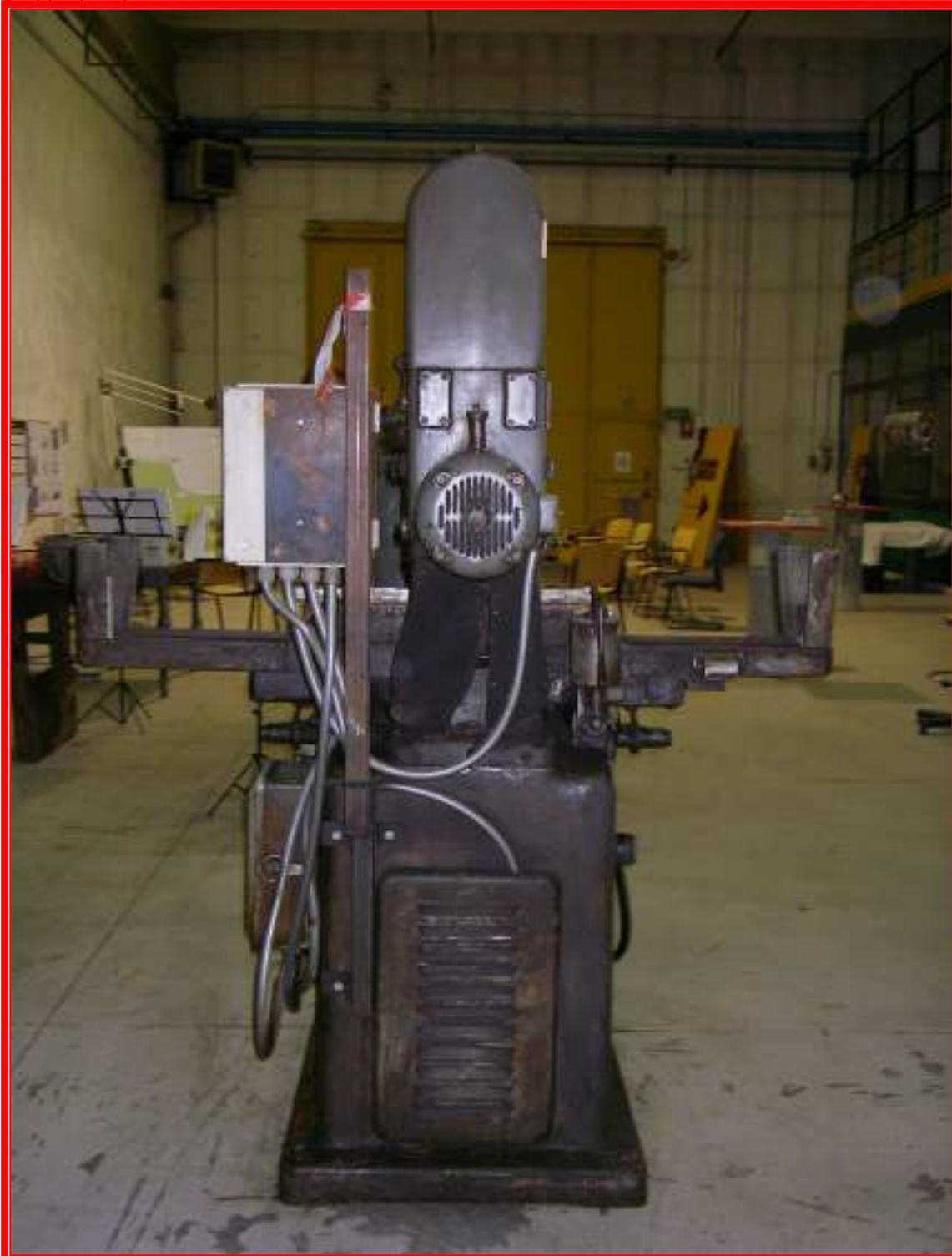
Fianco delle rettificatrice: volantino di regolazione verticale testa porta mola, mola e gruppo rinvivatore, quadri di derivazione elettrica, carter tavola porta pezzo, comando idraulico di avanzamento longitudinale ed inversione della tavola, volantini regolazione manuale dello spostamento longitudinale e trasversale della tavola, condotti oleodinamici, pulsantiera avviamento e arresto
